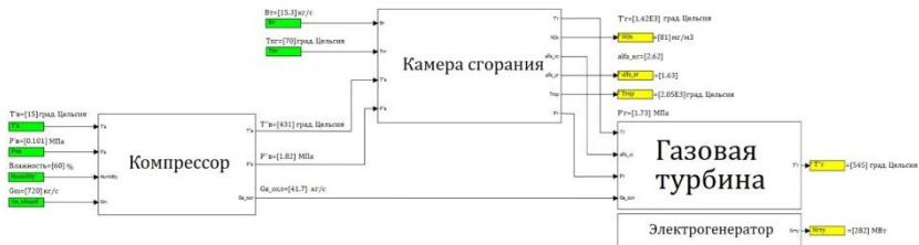
Рис. 1. Обобщенная структурная схема модели ГТУ в SimInTech
